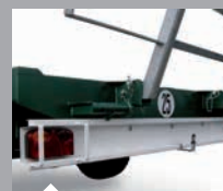
Éclairage arrière type poids lourd sur barre à feux avec support gyrophare en standard
