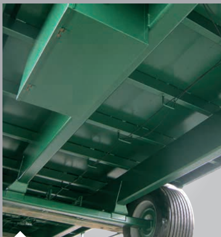
Longerons tubulaires HLE 300 x 100 ép. 8 mm Traverses sous plancher en tube de 100 x 50 x 3.2 mm
