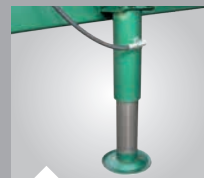
Béquille hydraulique par distributeur tracteur en std
